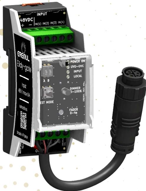
Le **"ELIDY-GATE"**, est "la tête de pont" du système Pixelidy. Au delà de fusionner l'alimentation 48V et le signal DMX sur une sortie unique, il permet surtout de protéger électriquement et d'isoler le signal de l'ensemble des périphériques branchés en aval.
