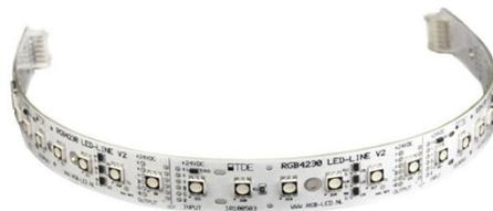
Module flexible RGB équipé de 30 Led haute puissance. Longueur : 420 mm – 5 sections sécables de 84 mm. Intégrable en profilé d'aluminium avec diffuseur PMMA.
